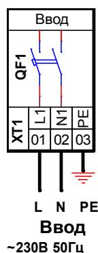
Примечание: В некоторых исполнениях шкафа клеммы XT1:(1,2) могут отсутствовать, фазный и нейтральный проводники электропитающего кабеля подключаются непосредственно к нижним зажимам автоматического выключателя QF1.
